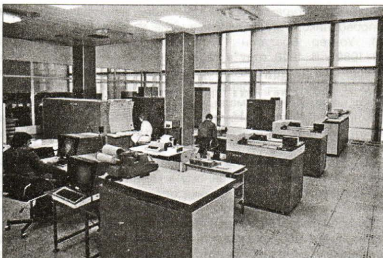
Рис. 2.3. Рабочее помещение с установленной ЕС-1060
